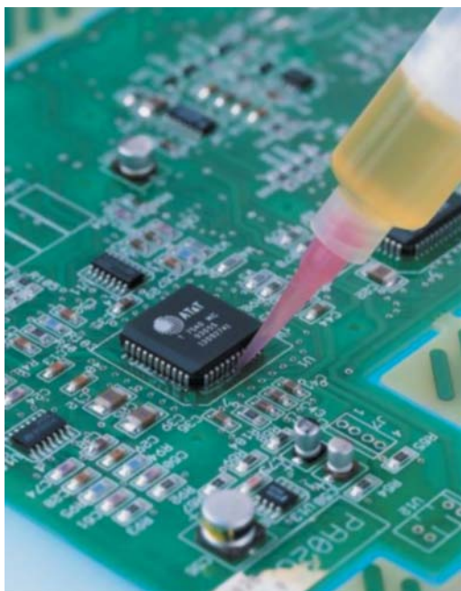
Рис. 1. Нанесение флюс-геля — в нужном месте в нужном объеме
